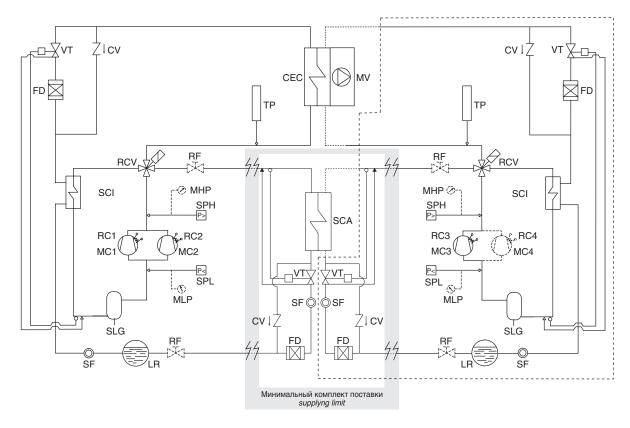
Компоненты, обозначенные пунктиром, относятся к агрегатам с четырьмя компрессорами (типоразмеры 102-162).
