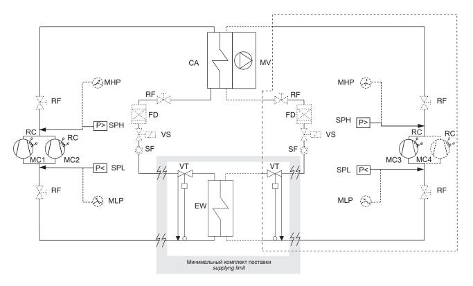
Компоненты, обозначенные пунктиром, относятся к агрегатам с четырьмя компрессорами (типоразмеры 102-162).
